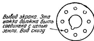
тому первое гнездо ламповой панельки должно быть соединено с цепью заземления (обычно минус батареи накала).
